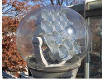
Se adaptó el sistema a las características climáticas del trópico, logrando captar los rayos solares siempre de manera perpendicular.
