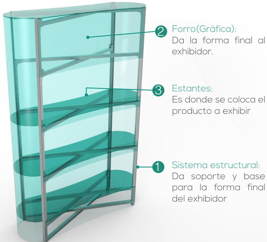
El sistema estructural propuesto esta formado por un módulo central base en forma de equis el cual esta configurado por un rectángulo y dos U unidos por un tornillo central, este tornillo permite el cambio de ángulo de la equis para incrementar la variedad de formas para el exhibidor y facilitar el transporte, además una de las U es desprendible para dar mayor posibilidad de configuraciones.
