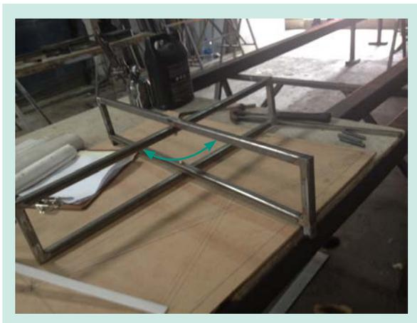
El módulo base viene armado solo hay que abrirlo en el ángulo deseado para comenzar a armar la estructura y colocarlo en un lugar adecuado y nivelarlo para la estabilidad del exhibidor.
