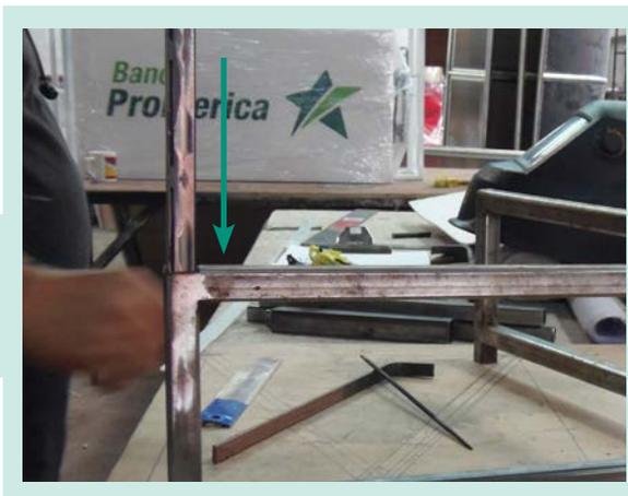
Las extensiones se meten en el módulo base solo encajando el tubo en el agujero que se encuentra en el extremo de la base.
