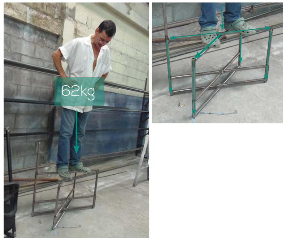
Cuando ya la estructura estaba armada se realizo pruebas con una caja de herramientas que pesaba 40kg y unos cuartos de pintura, este peso se dejo por un día y la estructura lo soporto sin sufrir ninguna deformación.
