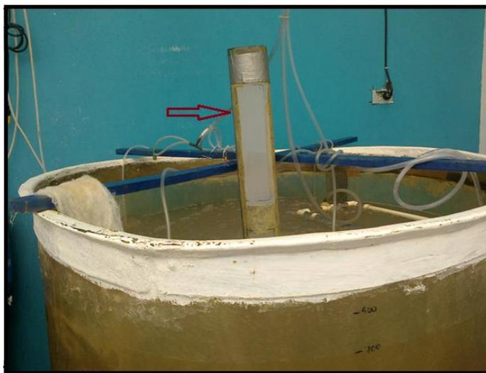
**Figura 34.** Filtro de  $53 \mu\text{m}$  que permite realizar los recambios de agua diarios.
