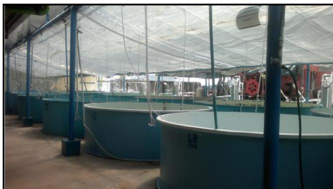
**Figura 31.** Tanques de 6 y 12 m<sup>3</sup> utilizados en la etapa de larvicultura.
