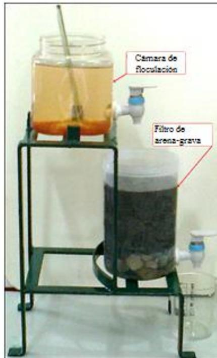
**Figura 2.7. Sistema de punto de uso desarrollado por Bordoloi, Nath, Gogoi, & Duttaa adaptado de Bordoloi, Nath, Gogoi, & Dutta (2013)**
