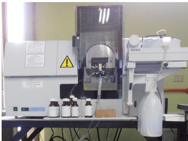
Figura 3.11. Espectrofotómetro de absorción atómica Perkin Elmer AAnalyst 800
