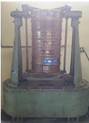
Figura 3.4. Agitador mecánico
