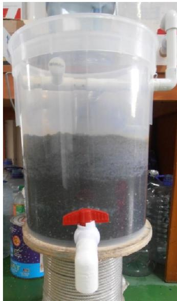
**Figura 3.10. Filtro del prototipo de remoción de arsénico**
