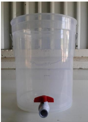
**Figura 3.5. Tanque de coagulación/floculación del prototipo de remoción de arsénico**
