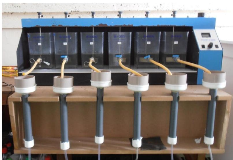
Figura 3.2. Aparato de jarras modificado con filtros de arena utilizado en los ensayos de remoción de arsénico
