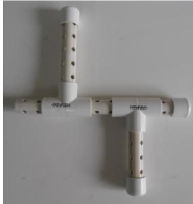
**Figura 3.7. Dispensador de agua para el filtro**
