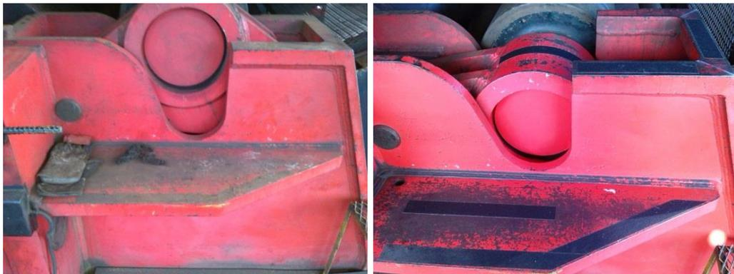
Figura 58. Antes y después de la limpieza en la dobladora
