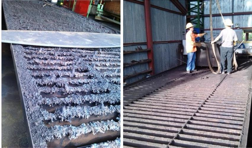
Figura 56. Antes y después de limpieza en la meza de corte
