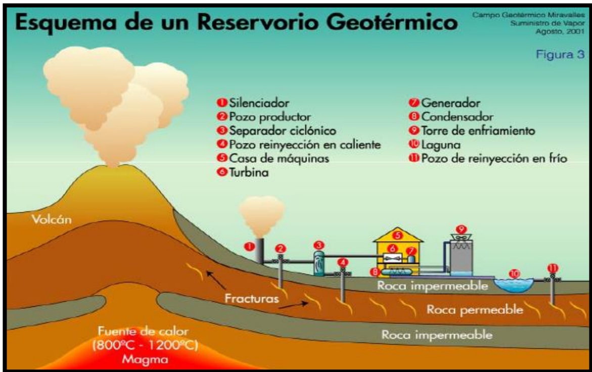
Figura 2.1 Funcionamiento de un campo geotérmico.
