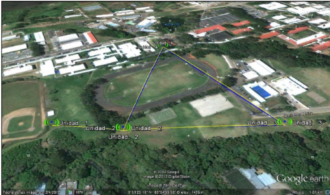
**Figura 4.157:** Campo de pruebas para la red de cuatro enlaces y un sumidero, usado para las pruebas de la red y su contraste por simulación mediante Radio Mobila. Tomada de [56].
