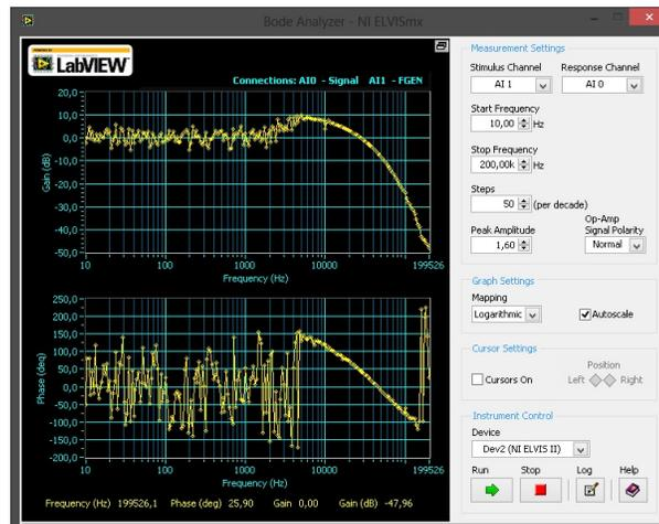
**Figura 4.3:** Respuesta de frecuencia del acondicionador de señal.
