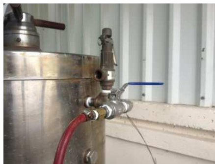
Figura 8. Toma de muestra gaseosa.
