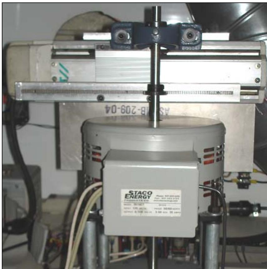
**Figura 6.1** Ensamble entre el actuador lineal y los transformadores
