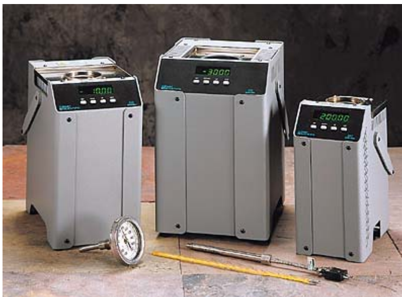
Figura 4. Sistema de calibración de la empresa Hart 3
