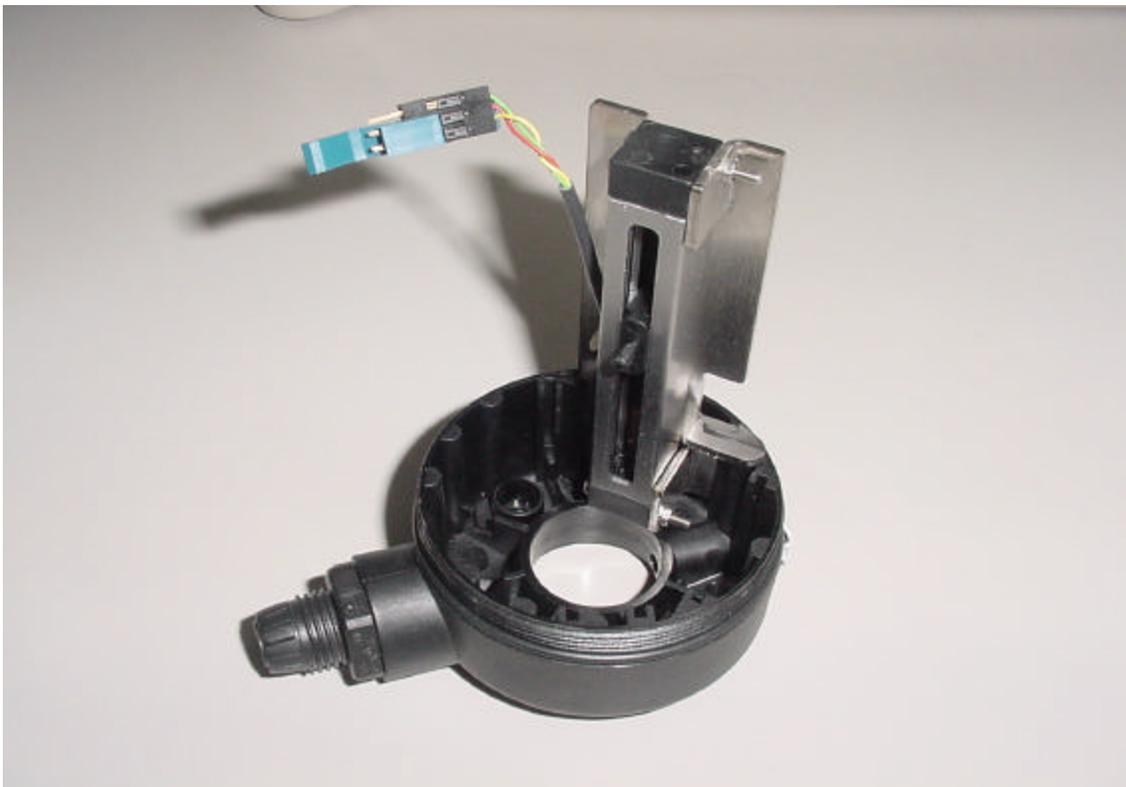
Foto 9: Subpartes: Puerto de conexión y riel
