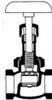
Figura 3.1.4 Válvula de globo.
