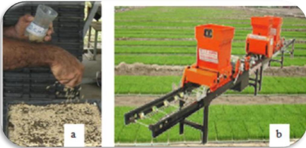
**Figura 21.** a) Siembra manual. b) Siembra mecanizada del semillero o almácigo de arroz. Conarroz, 2011.
