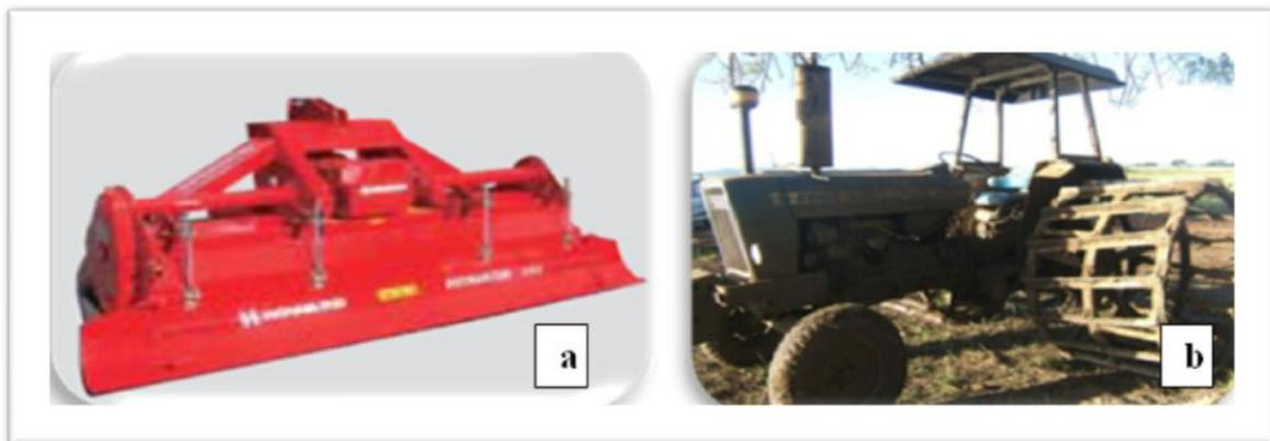
**Figura 6.** Implementos para la preparación del terreno. a) Roto cultivador. b) Fanguador. Conarroz, 2011.
