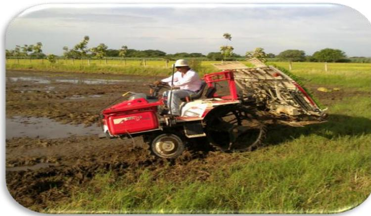
**Figura 34.** Trasplantadora de arroz autopropulsada. Conarroz, 2011.
