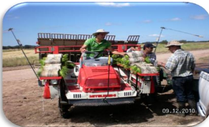
**Figura 39.** Máquina trasplantadora autopropulsada MPR8D, propiedad de Conarroz. Fuente: Conarroz, 2011.
