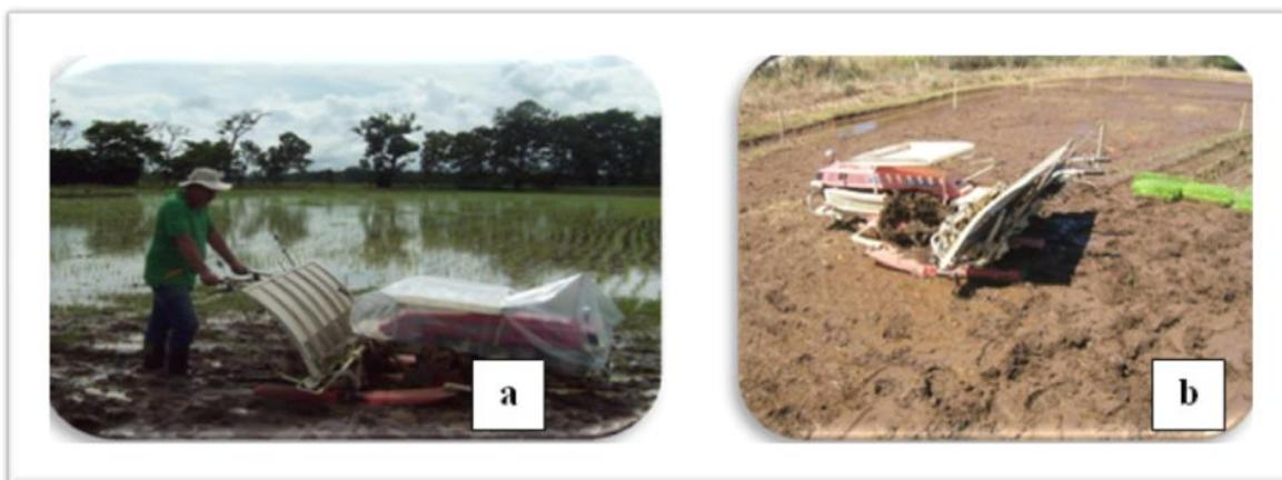
**Figura 32.** a), b). Trasplantadora de arroz de operación manual, propiedad del INTA de Costa Rica. Conarroz, 2011.
