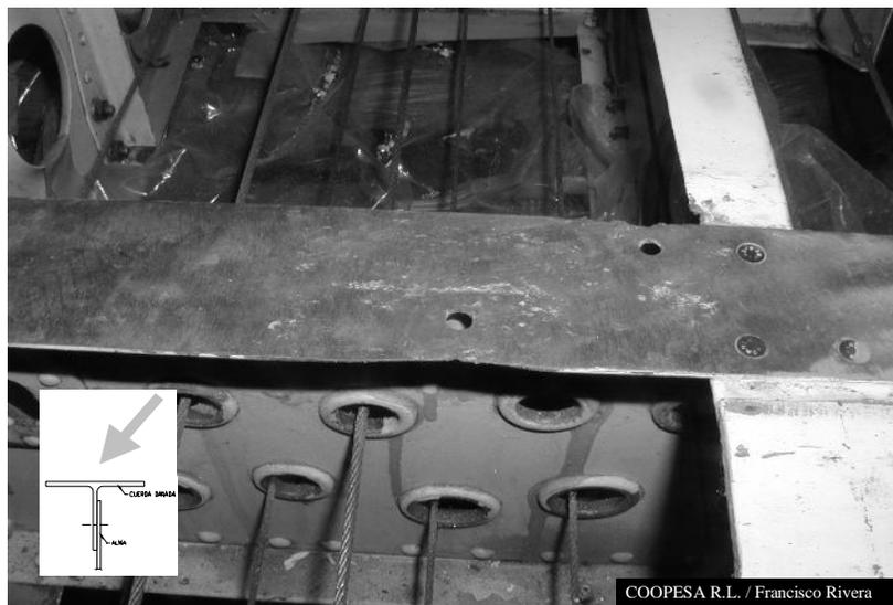
Figura 2-9. Fotografía. Corrosión en la cuerda superior.
