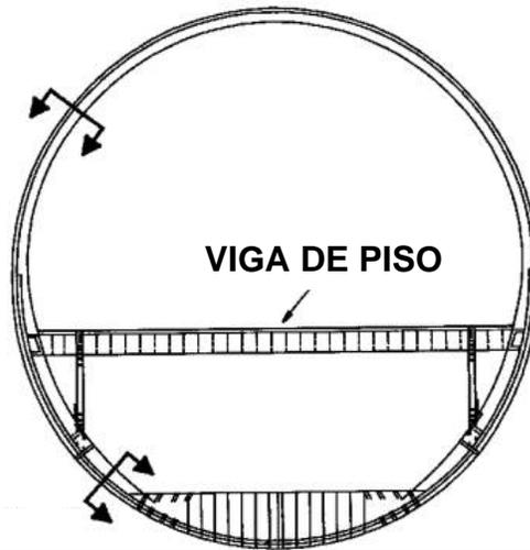
Figura 2-3. Corte transversal del fuselaje. Viga de piso.<sup>14</sup>
