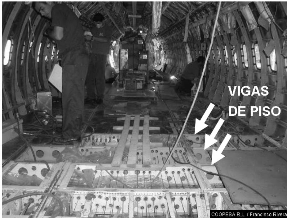
Figura 2-4. Fotografía. Estructura interna del fuselaje. Vigas de piso.
