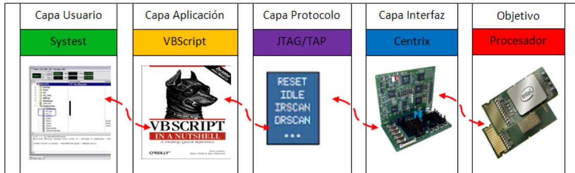
Figura 5.1 Diagrama de alto nivel de la solución seleccionada
