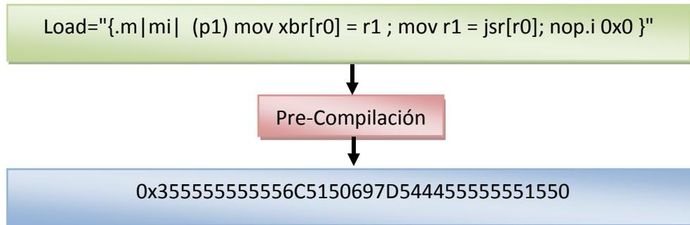
Figura 5.13 Ejemplo de Load y su equivalente hexadecimal.
