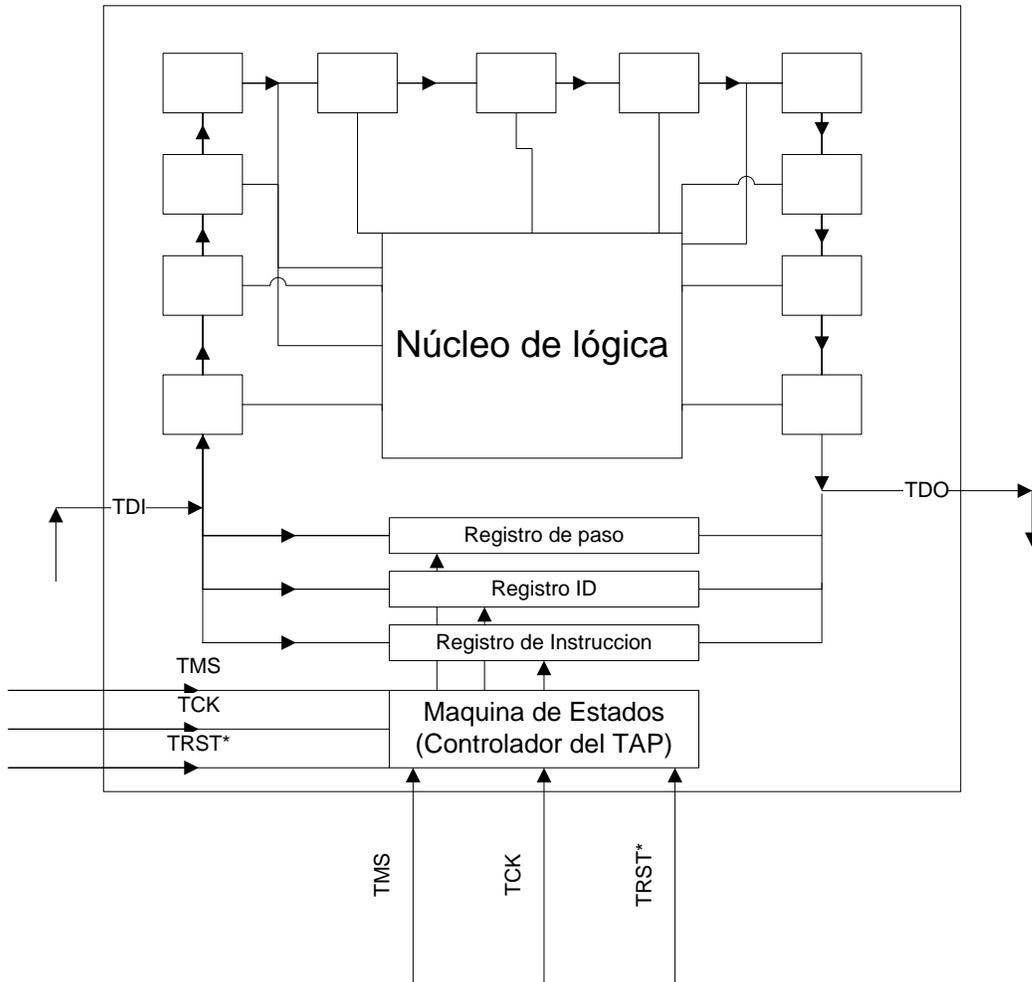
Figura 3.7 Ejemplo de un Chip con Boundary-Scan.
