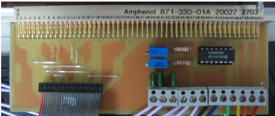
**Figura 27** Tarjeta de acople Fuente-Mux/Demux-Motherboard
