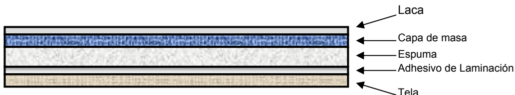
Figura 2. 2 Conformación de un vinilo terminado
