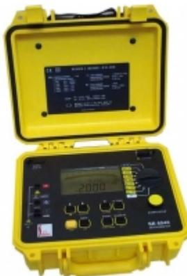
Figura 48. Medidor de resistencia de aislamiento *Megger*.
