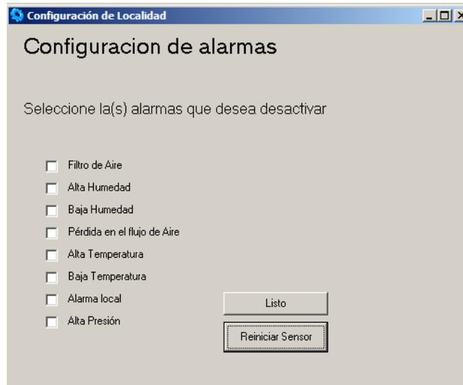
**Figura A.9** Configuración de alarmas y reinicio de sensor.
