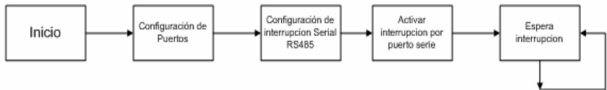
**Figura 12** Esquema principal de la programación del microcontrolador.
