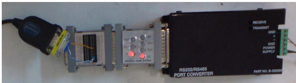
**Figura 19** Conexión del convertidor de puerto RS-485 a RS-232
