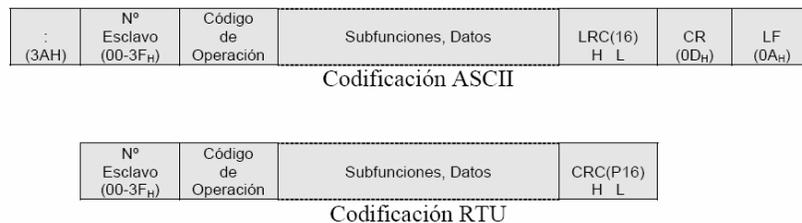
**Figura 3** Tipos de codificaciones según el protocolo MODBUS.
