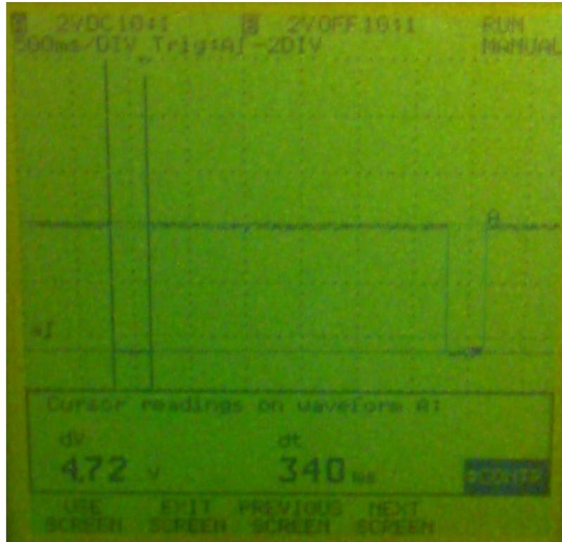
**Figura 23** Tiempo de respuesta del microcontrolador ante una petición MODBUS.
