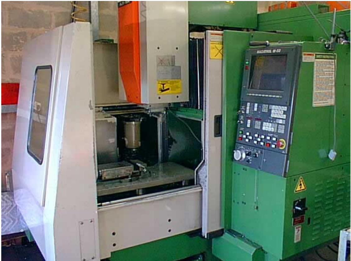
FIGURA 12. CENTRO DE MAQUINADO MAZAK AJV-18N
