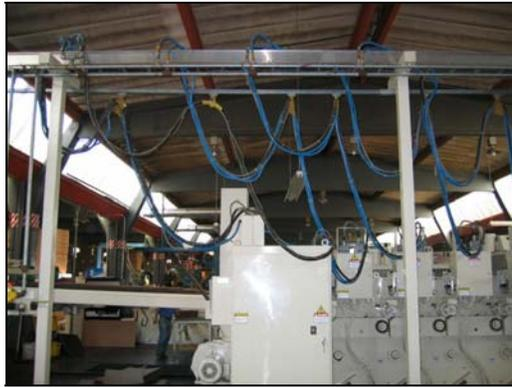
1. Tuberías de agua y aire sin pintar. Mangueras de aire y agua del mismo color
