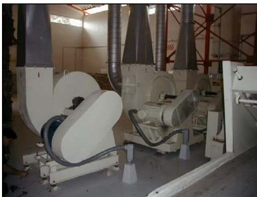
**Figura 1-16** Turbinas Área Embaladora
