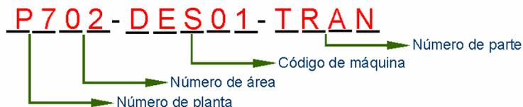
**Figura 3.4 Ejemplo de codificación para las unidades de mantenimiento.**
