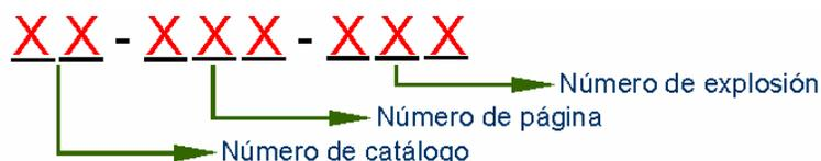
**Figura 3.1 Codificación de los repuestos en el catálogo de máquinas.**
