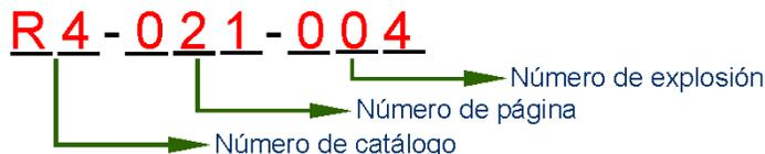
**Figura 3.2 Ejemplo de la codificación de los repuestos en el catálogo de máquinas.**
