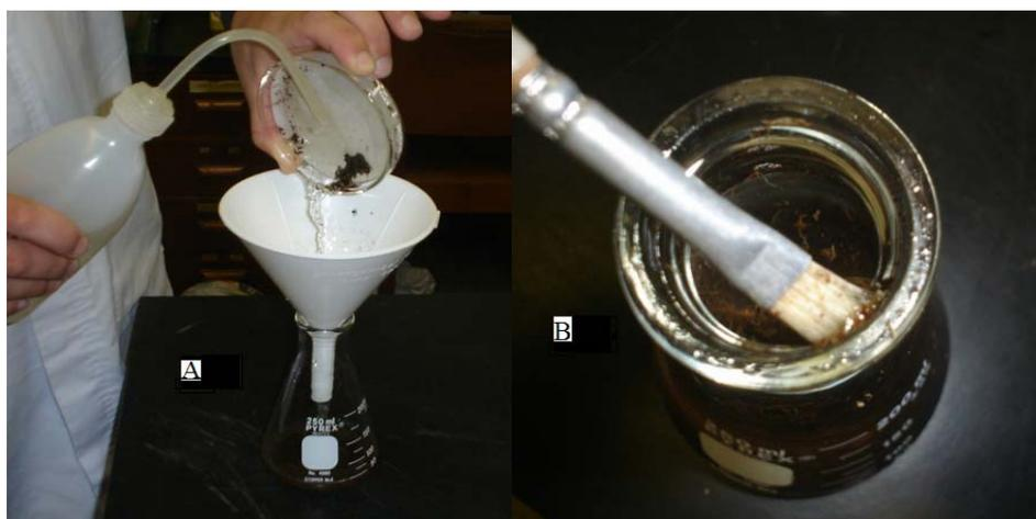
**Figura 4. Método de la acetona para la separación de quistes de la materia orgánica. A Incorporación de los quistes y de la materia orgánica al erlenmeyer con acetona, B Recuperación de quistes con pincel.**
