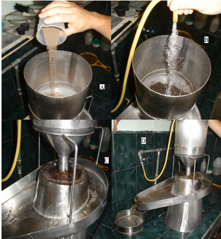
**Figura 3. Extracción de quistes por el método de Fenwick. A Incorporación de la muestra de suelo, B Dispersión de las partículas del suelo con agua a presión, C Flotación de quistes y materia orgánica hasta el cuello del Fenwick, D Recolecta en criba de 100 mesh.**
