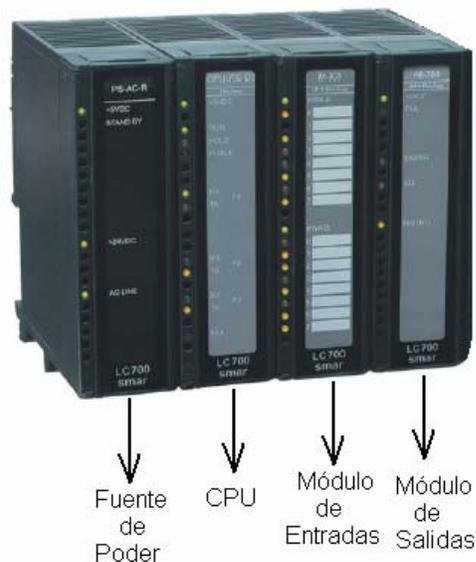
**Figura 4.2** Diagrama de la ubicación del CPU en el rack de montaje [Ref. 6]
