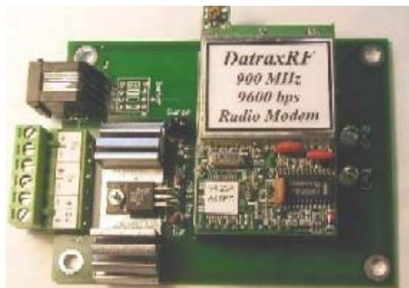
Figura A.6.3 MODEM Inalámbrico con interfase DataraxRF
