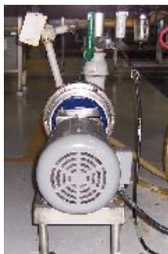
Figura 5.3.13. Motor bomba de llenado.
