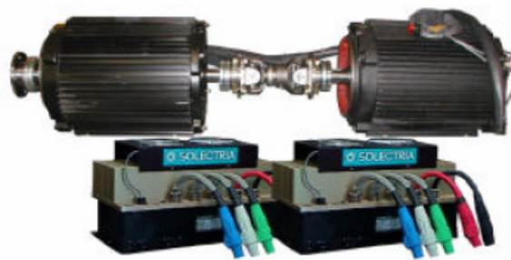
Figura 1.2 Forma de conexión de dos motores.
