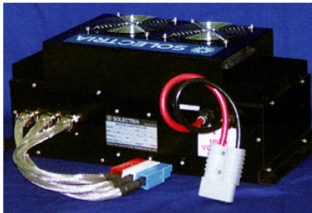
Figura 1.1 Caja del sistema controlador de velocidad existente UMOC440T
