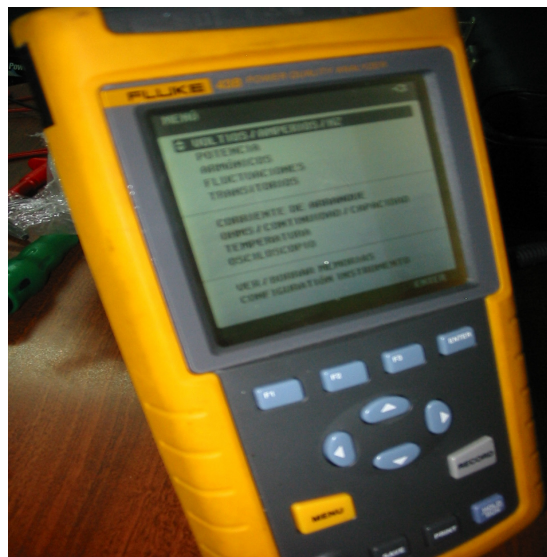
Figura 6.30 Instrumento de medición osciloscopio digital FLUKE 43B
