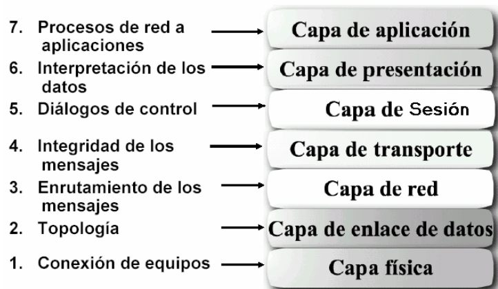
Figura 3.1: Ilustración de las capas del modelo OSI
