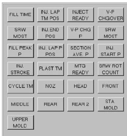
Figura 12: Pantalla para seleccionar las variables a monitorear.
