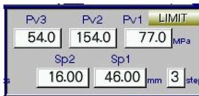
Figura 5: Pantalla para el cambio de los valores de presión pico de llenado.
