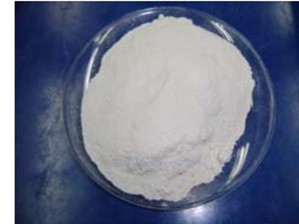
Molienda del lodo seco en molino de martillos
