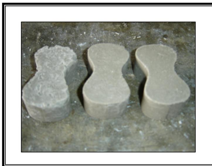
**Figura 19. Briquetas moldeadas al 25% de lodo (mezcla 2)**
