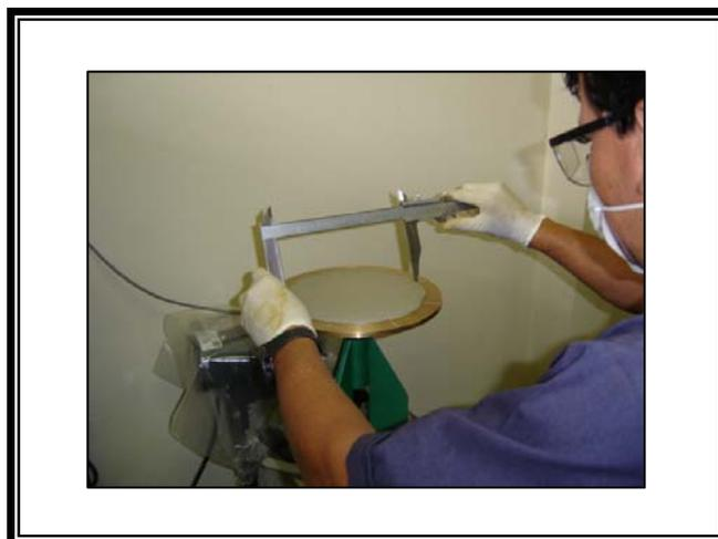
**Figura 7. Determinación de la fluidez de una mezcla de cemento**
