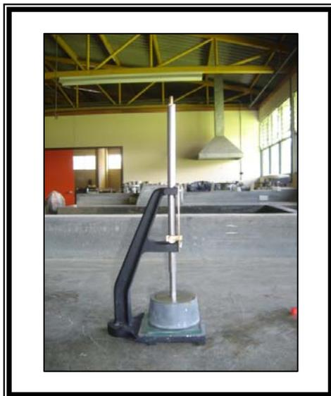
**Figura 8. Equipo de Vicat para la determinación de Consistencia Normal**
