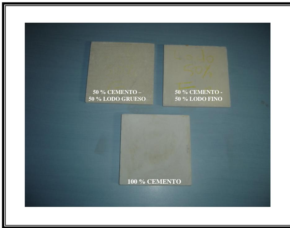
**Figura 29. Placas de cemento y lodo cemento para la determinación de la conductividad térmica**
