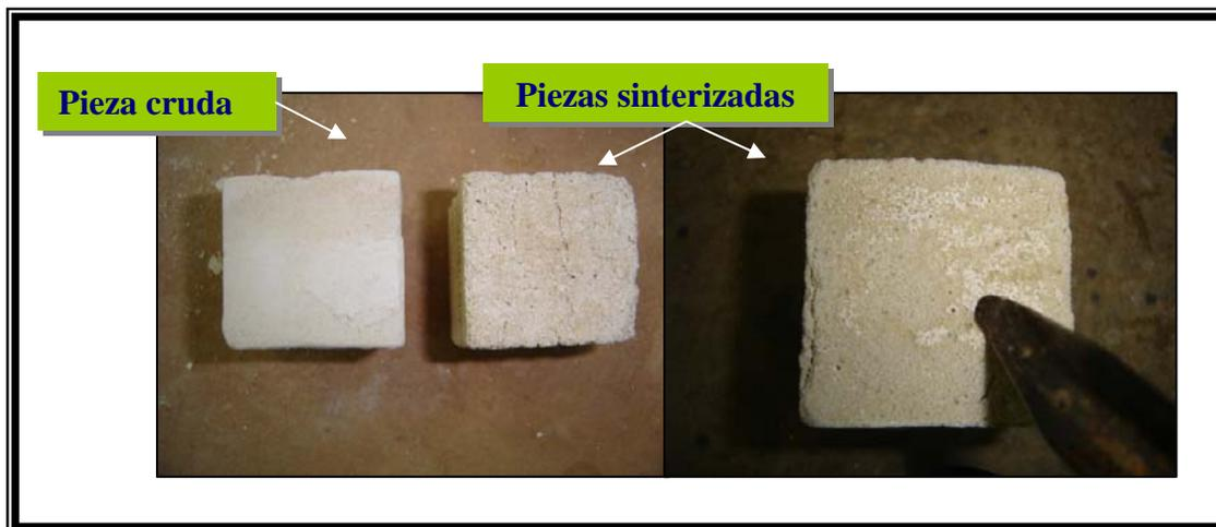
**Figura 25. Especímenes sinterizados de la mezcla 50% lodo-50% cemento.**
