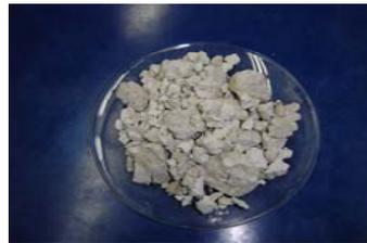
Secado del lodo en estufa a 110°C por 24 horas
