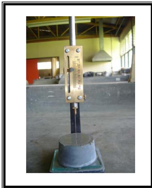
**Figura 13. Equipo de Vicat para la determinación de los tiempos de fragua.**
