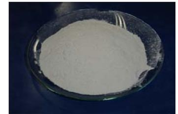
Tamizado del lodo a malla #100 (150  $\mu\text{m}$ )
