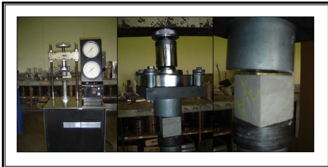
**Figura21. Equipo de medición para la resistencia a la compresión de un cemento.**
