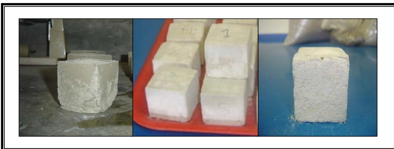
**Figura 22. Cubos moldeados (de izquierda a derecha) al 25% 50% y 75% de lodo respectivamente.**
