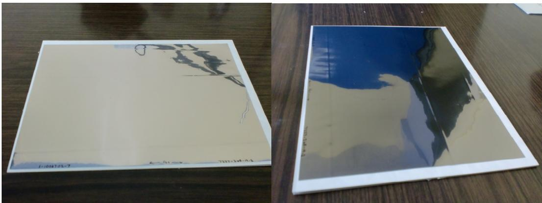
**Figura 4.4.14. Lámina de material piezoeléctrico PVDF**
