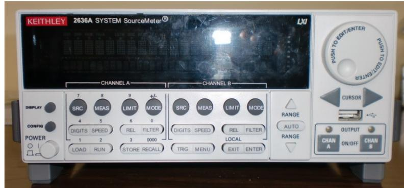
**Figura 4.3.40. Imagen del dispositivo para la medición de la potencia consumida por los elementos de actuación (Unidad fuente-medidora Keithley 2636A).**
