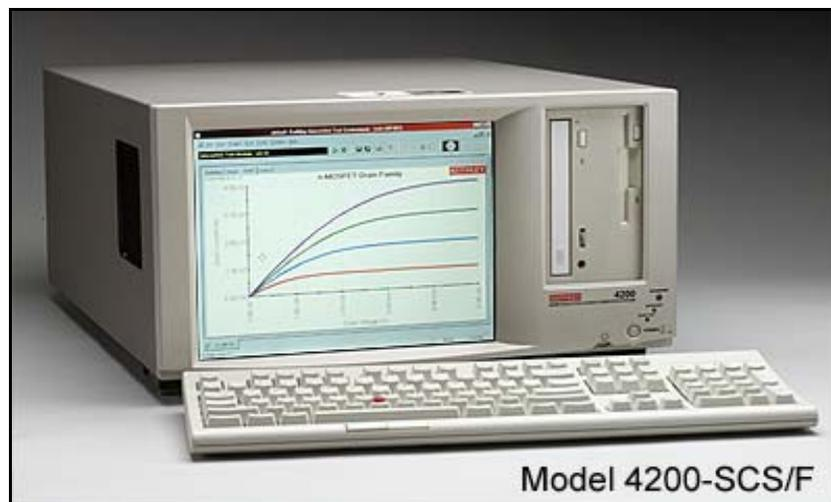
**Figura 2.6. Sistema de caracterización eléctrica con cuatro canales fuente medidor modelo 4200SCS Marca Keithley [6]**
