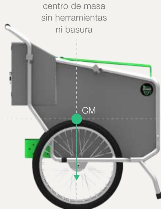
El centro de masa del sistema móvil sin herramientas ni basura, se encuentra un poco más abajo del centro geométrico del sistema, ya con estos extras el centro de masa se desplaza un poco hacia adelante y abajo.
