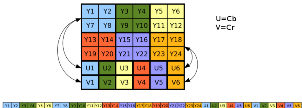
Figura 2.29.: Estructura de un búfer del formato I_{420}
