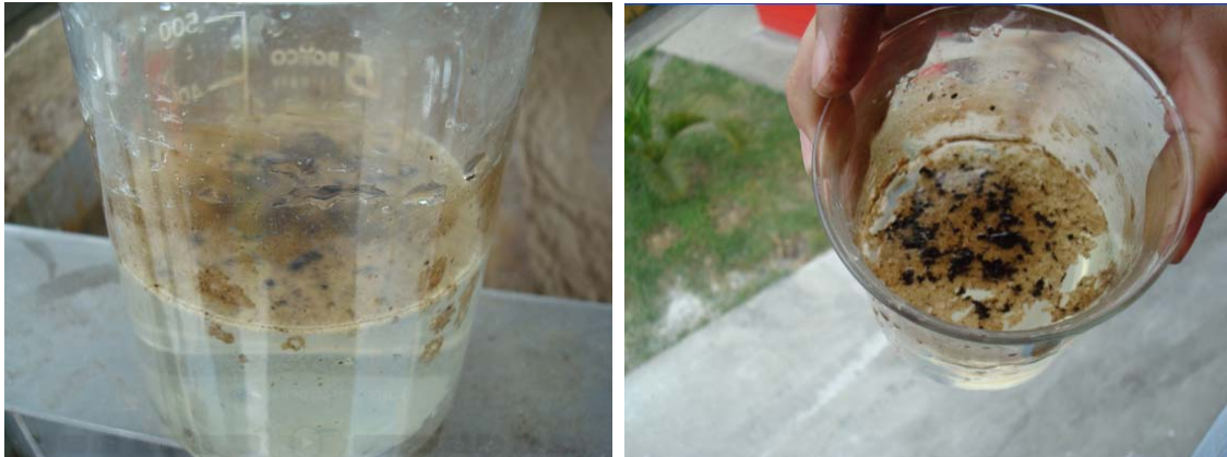
Figura 36. Prueba con 160 ppm de Coagulante PIX y 16 ppm de Floculante 4893
