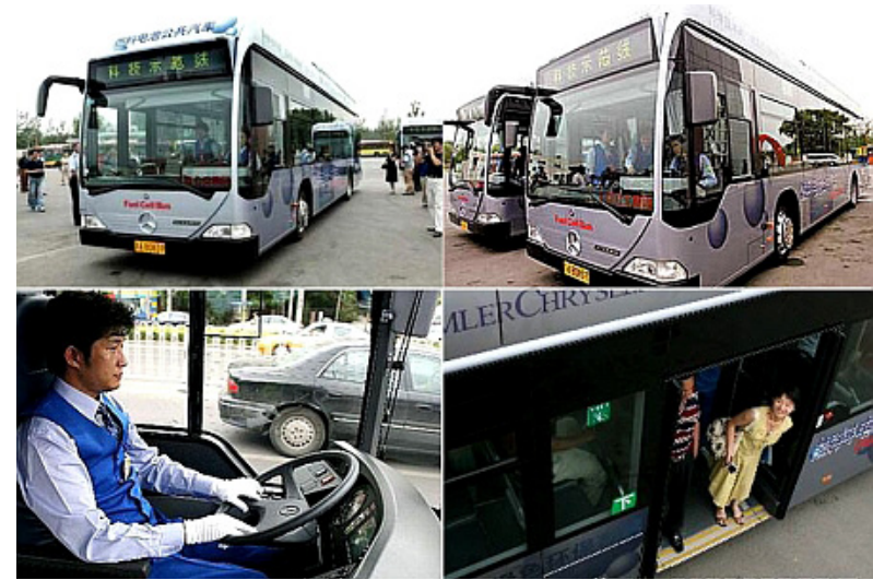
Imagen 11. Fuel Cell Buses (FCB). Transporte público en China que funciona con hidrógeno
