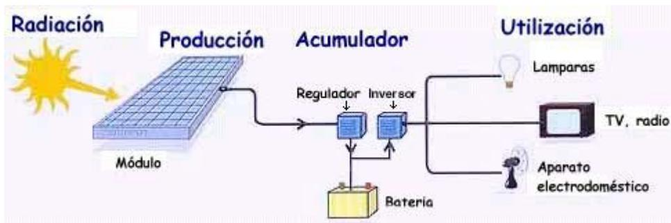
Figura 2.4 Una instalación solar fotovoltaica con inversor, utilización a 110 ó 230Vca
