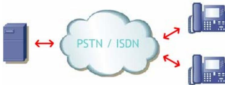
**Figura 5.1.1** Diagrama de bloques del sistema de mensajería en telefonía fija
