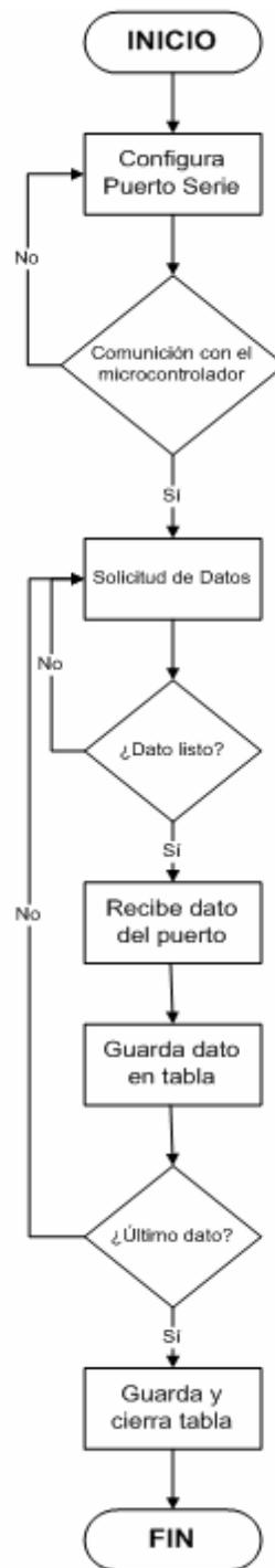
Figura 5. 14 Diagrama de flujo para el programa de la PC del operador
