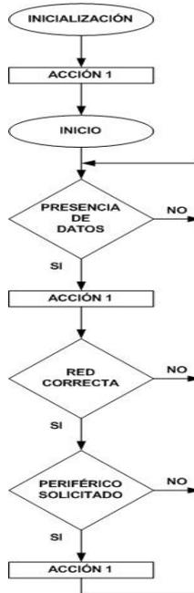
**Figura 5.20** Diagrama de flujo para la rutina de medición y envío de datos en periféricos
