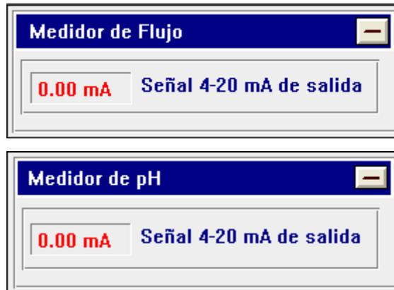
Figura 4.5 Ventanas auxiliares para los medidores de flujo y pH
