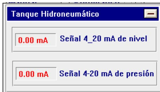
Figura 4.12 Ventana auxiliar para tanque hidroneumático
