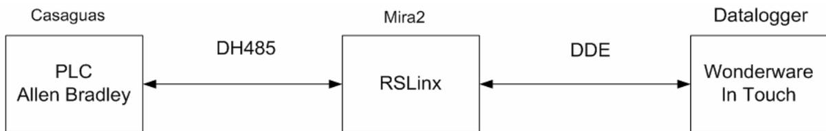
**Figura 3.7** Diagrama de bloques para comunicación PLC-Wonderware
