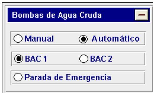
**Figura 4.9** Ventana auxiliar para bombas de agua cruda
