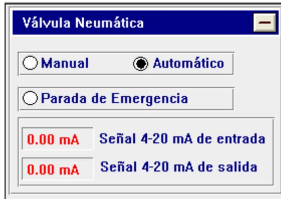
Figura 4.4 Ventana auxiliar para la válvula neumática
