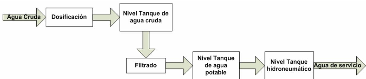
Figura 5.10 Módulos del sistema de dosificación
