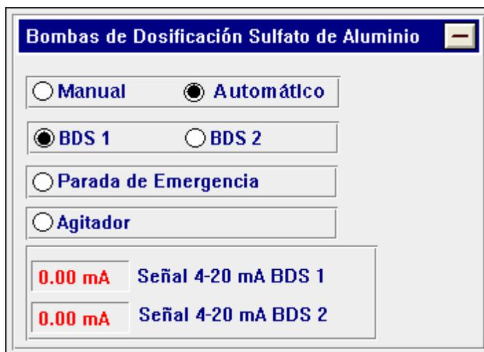
**Figura 4.8** Ventana auxiliar para la bomba de dosificación de sulfato de aluminio
