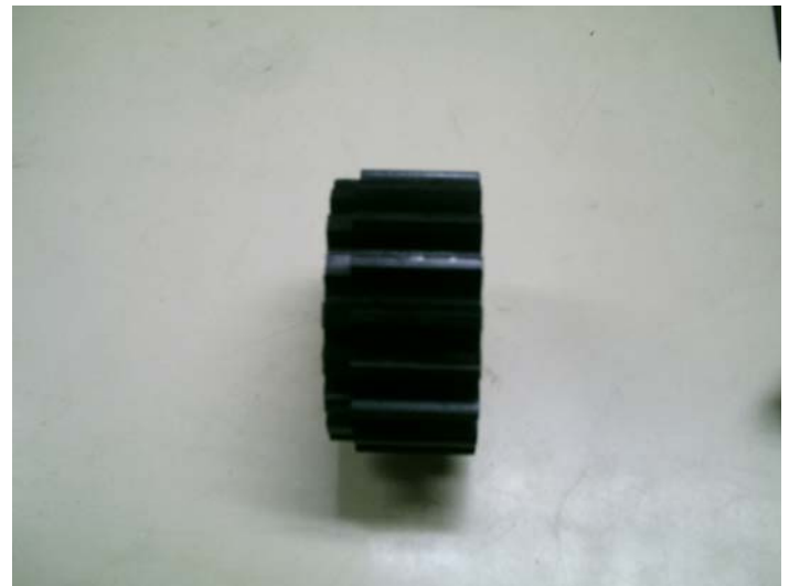
Figura 4.6: Muestra y engranaje inadecuadamente templado.
