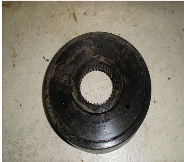
Figura 4.11: Engranaje de acero F – 1140 (1045) templado incorrectamente.
