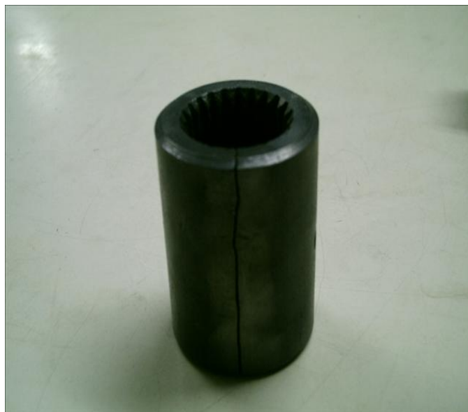
Figura 4.8: Acople que se agrietó por segundo temple sin previo alivio de tensiones.
