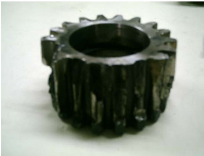
Figura 4.6: Muestra y engranaje inadecuadamente templado.
