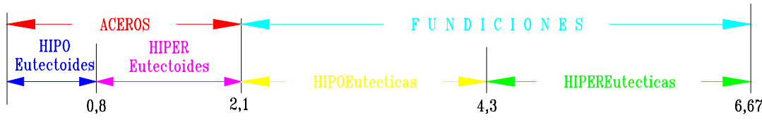
DIAGRAMA ESTABLE Hierro-Grafito: Temperatura Eutectica 1153 °C Temperatura Eutectoide 738 °C
