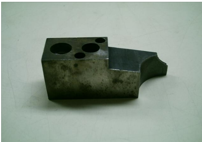
Figura 4.7: Cuchilla de troquel de poca tenacidad y mal alineada.
