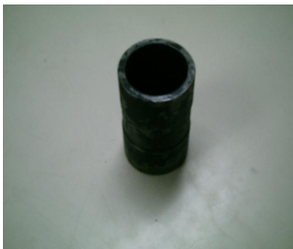
Figura 4.9: Cojinete templado y cementado.
