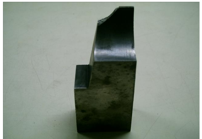
Figura 4.7: Cuchilla de troquel de poca tenacidad y mal alineada.
