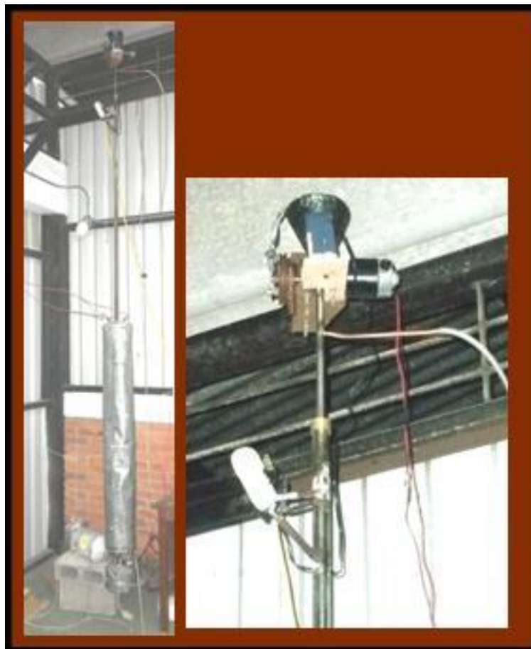
Fotografía del pirolizador de caída libre (izquierda) y detalle del alimentador.
