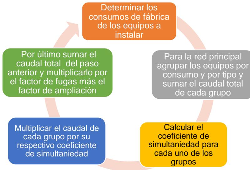
Figura 25. Ciclo para cálculo de caudal de diseño
