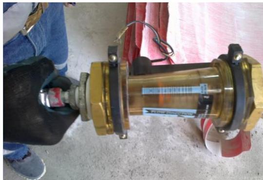
Figura 54. Medición de consumo de aire de mangueras de enfriamiento y estaciones de servicio.
