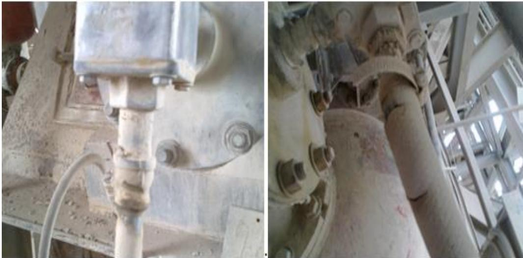
Figura 42. Fugas detectadas en la torre con detector ultrasónico
