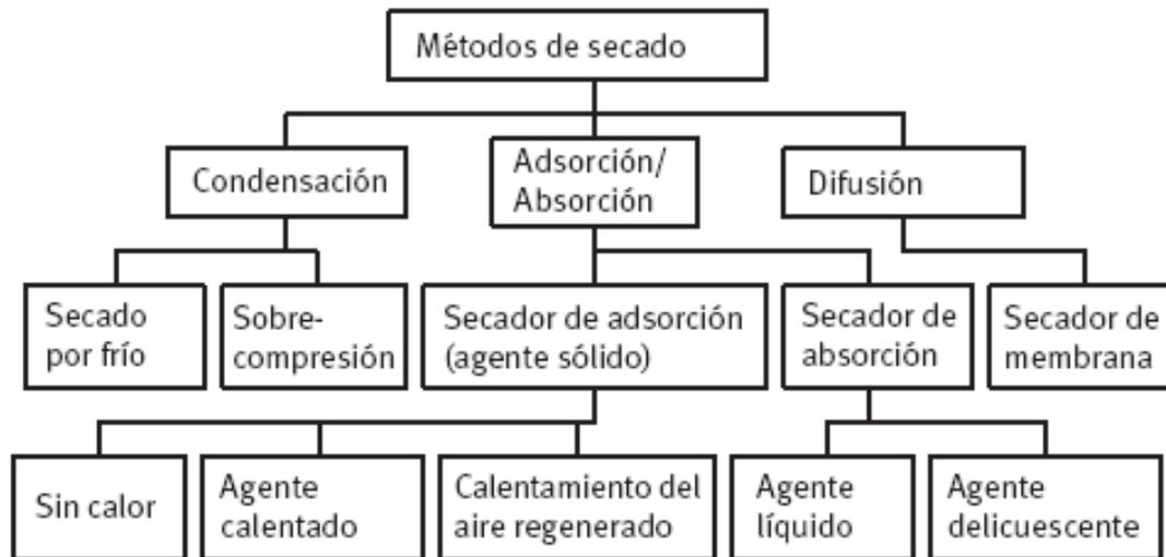
Figura 13. Tipos de métodos de secado
