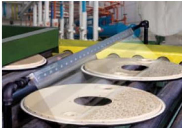
Figura 41. Sistema moderno de cuchillas de aire.
