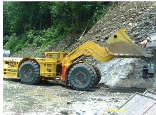
Ilustración 1. Pala cargadora frontal de bajo perfil
