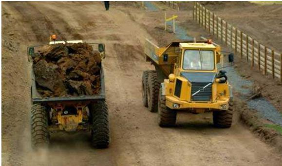
Ilustración 2. Dumpers utilizados para extracción de escombros.
