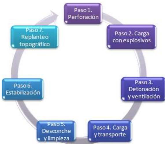
Figura 1. Ciclo de Perforación y Voladura
