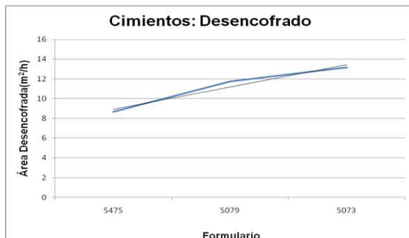
Figura 41. Gráfico de promedio de área desencofrada en cimientos. Fuente: datos del formulario F-01
