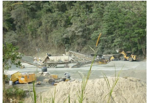
Figura 3. Quebrador utilizado para producir arena. Fotografía tomada el 21 de enero del 2010 en el sitio de Presa del Proyecto Hidroeléctrico Pirrís. Fuente: elaboración propia
