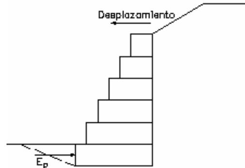
Figura 18. Efecto del empuje pasivo<sup>3</sup>.
