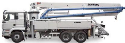
Figura 12. Bomba telescópica
