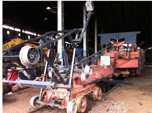
**Figura 68.** Niveladora de Incofer (Fairmont Tamper X-06), (Fuente: Autor)
