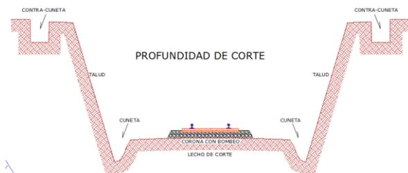
**Figura 12.** Sección de la vía sobre lecho de corte. (Fuente: Autor)
