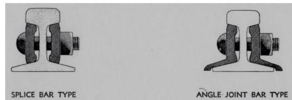
Figura 23. Detalles de tipos de eclisas. (Fuente: Incofer)
