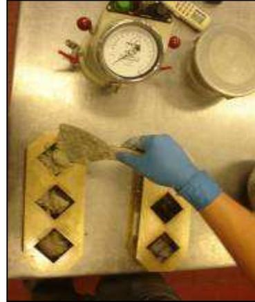
**Figura 33.** Moldeo de cubos de mortero.
