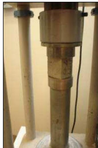
**Figura 27.** Ensayo de compresión de mortero.
