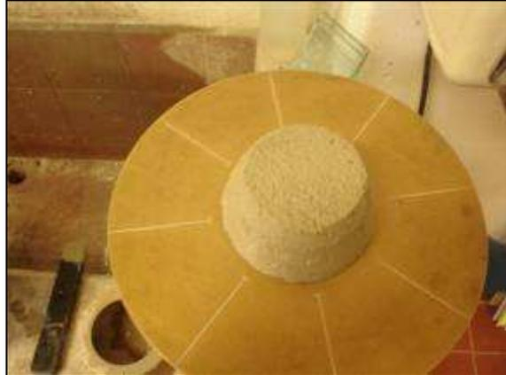
**Figura 29.** Muestra mortero en Ensayo de Flujo.
