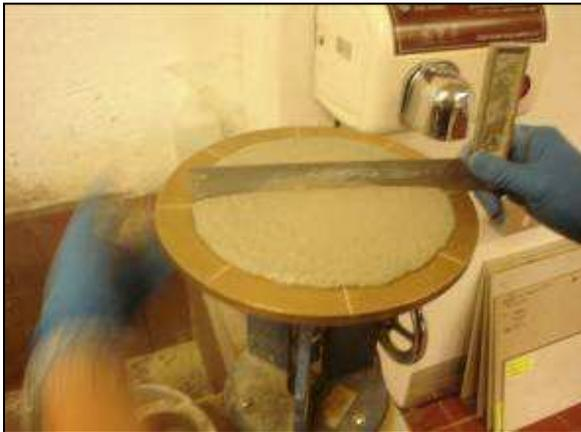
**Figura 30.** Medición del diámetro en ensayo de flujo.
