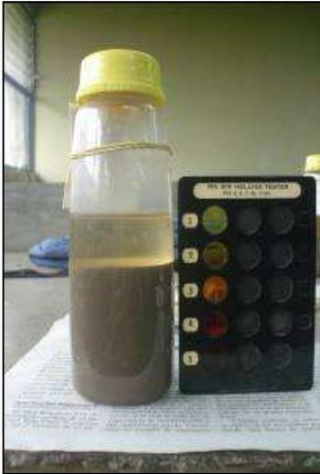
**Figura 24.** Ensayo Colorimetría Proyecto Zona Central GAM.
