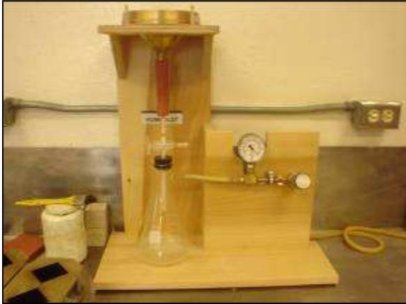
**Figura 32.** Equipo retención de Agua.
