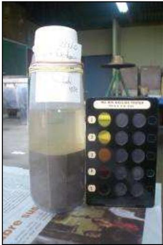
**Figura 20.** Ensayo Colorimetría Proyecto Zona Norte GAM
