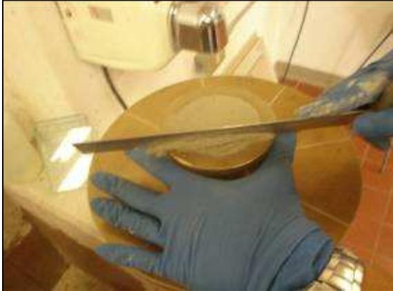
**Figura 28.** Ensayo de Flujo realizado al mortero.
