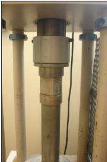
**Figura 26.** Falla a compresión de cubo de mortero.
