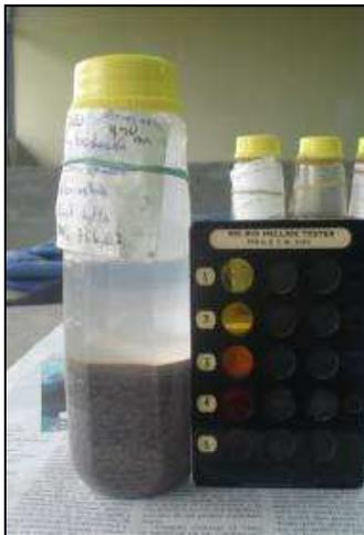
**Figura 22.** Ensayo Colorimetría Proyecto Zona Oeste GAM.
