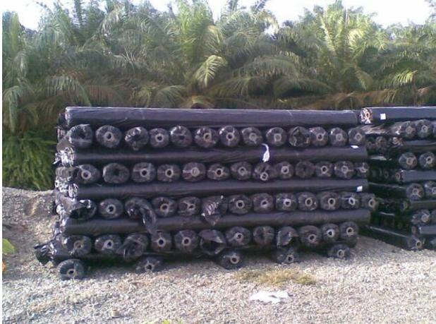
**Figura 27.** Rollos de geomalla utilizados en el proyecto.
