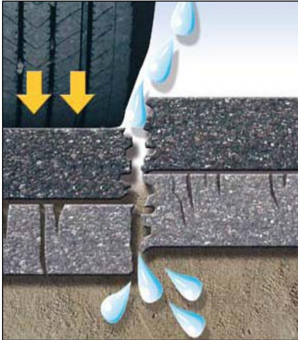
**Figura 11** Sin la geomalla de pavimentación se producirá una rápida reflexión de las grietas desde la antigua a la nueva capa asfáltica y además el agua superficial penetrará sobre la capa antigua de asfalto. Esta situación acelerará el deterioro en la construcción de la carretera.
