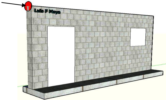
Figura 2. Ubicación de la carga lateral P en los muros. Tipo de muro 2.
