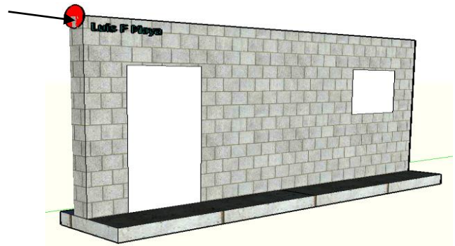
Figura 2. Ubicación de la carga lateral P en los muros. Tipo de muro 2.
