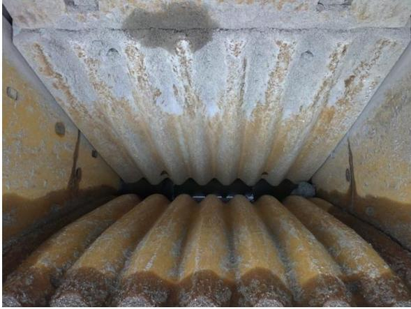
**Figura 23.** Vista Superior de las "muelas" del quebrador primario.
