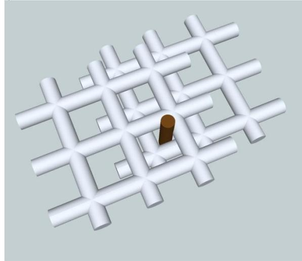
**Figura 32.** Esquema de la unión actual de tamices.
