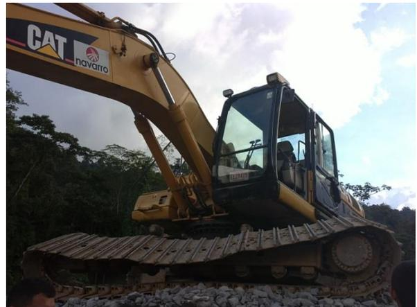
Figura 22. Excavadora inhabilitada por descarrilamiento de su tren de rodaje.
