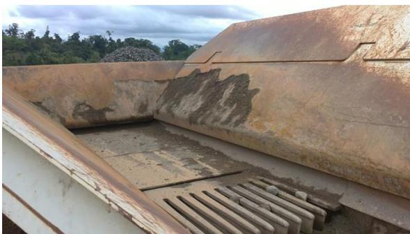
**Figura 6.** Alimentador del quebrador primario.
