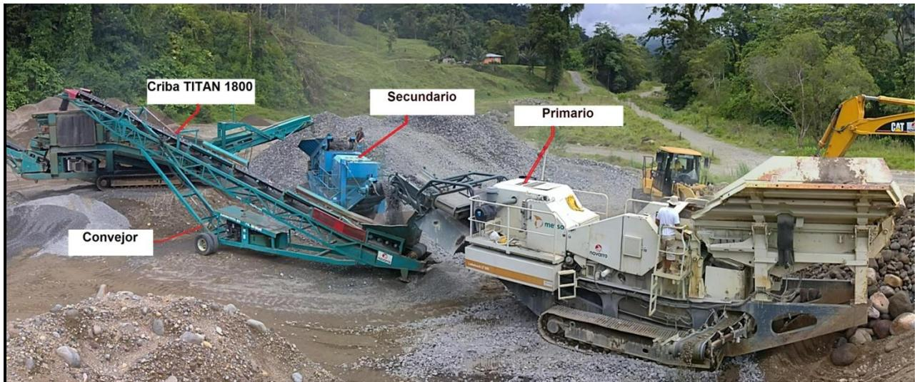
Figura 14. Distribución del los equipos trituradores y separadores del quebrador
